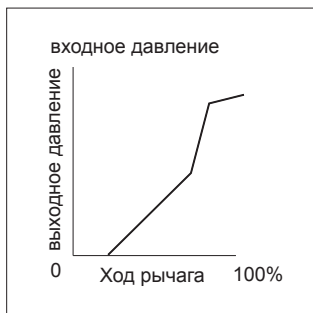
Регулирование с подачей полного давления
