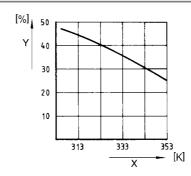
X) Ambient temperature range, Y) Tolerance
