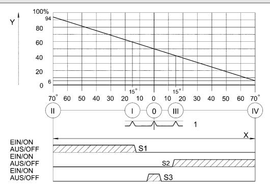
1) Lock position, X) Handle travel, Y) Voltage, S1-S3) Switches 1-3
