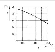
X) Ambient temperature range, Y) Tolerance
