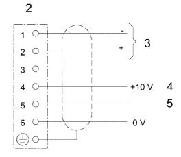
2) Plug 2 3) PWM-Signal of Mini-Marex actuator 1) Plug 1 4) Output 5) Input signal
