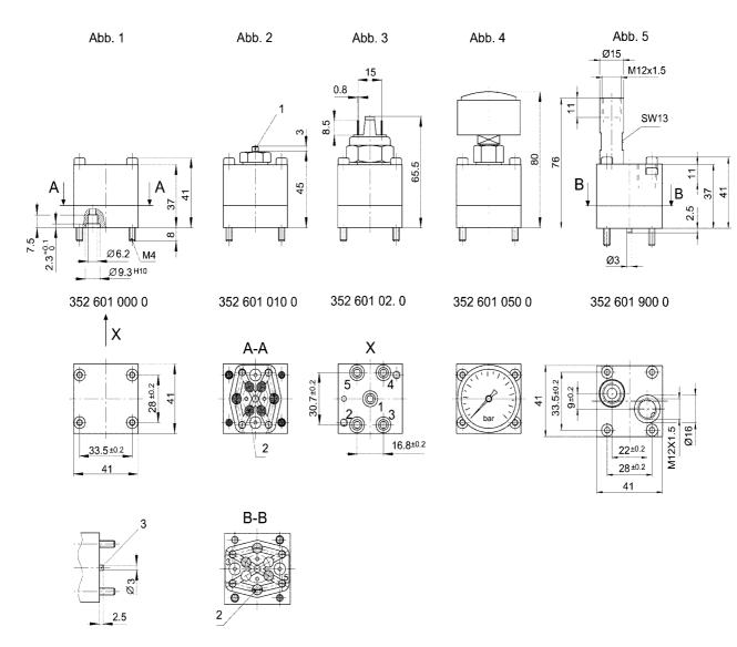
1) Check pin, 2) Plug, 3) Dowel pin
